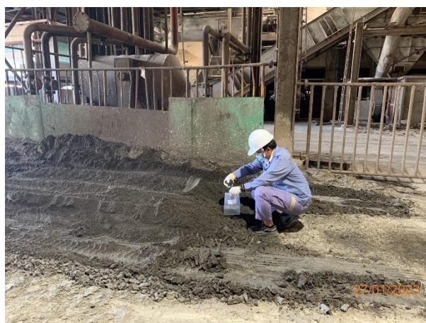
รูปที่ 3.4-10 การเก็บตัวอย่างกากตะกอนหม้อกรองของโครงการ
